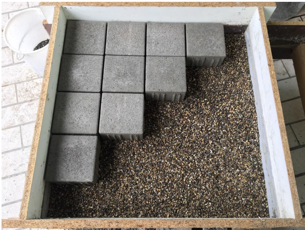
Abbildung 1: Verlegung der Pflastersteine im Hartsteinsplitt 2/5 mm
