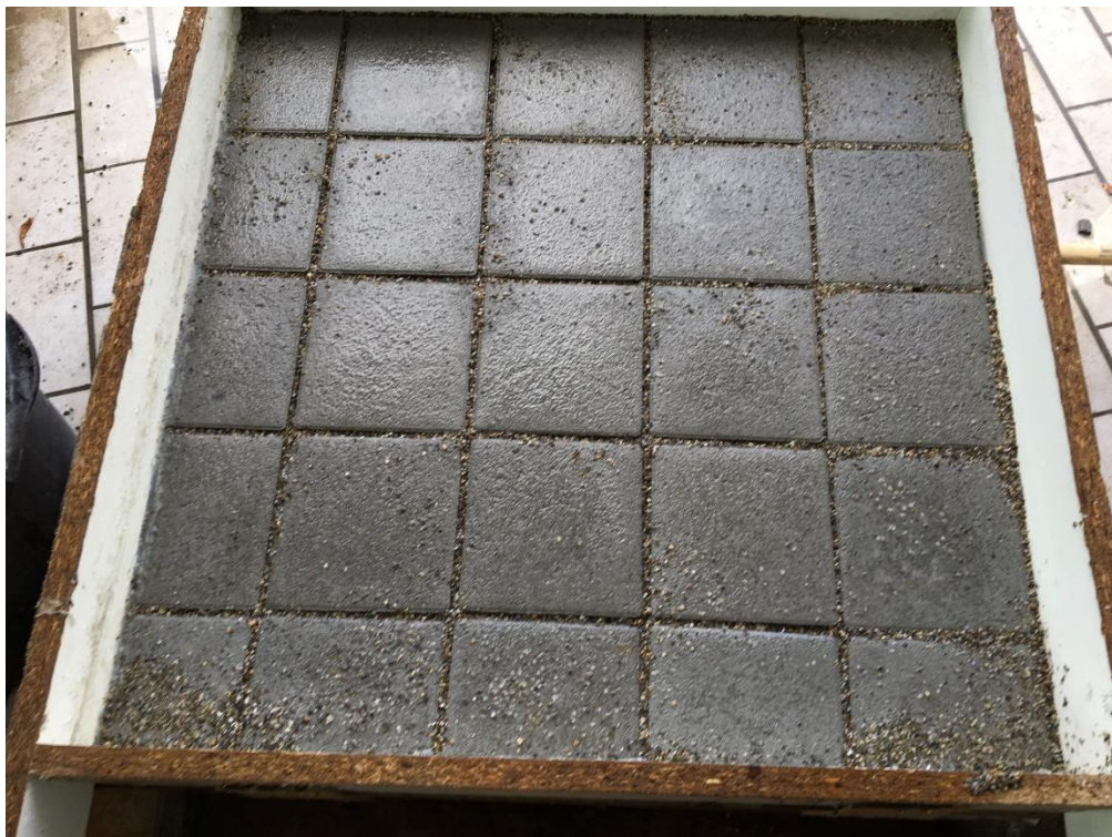
Abbildung 3: Prüfläche mit Fugenverfüllung
